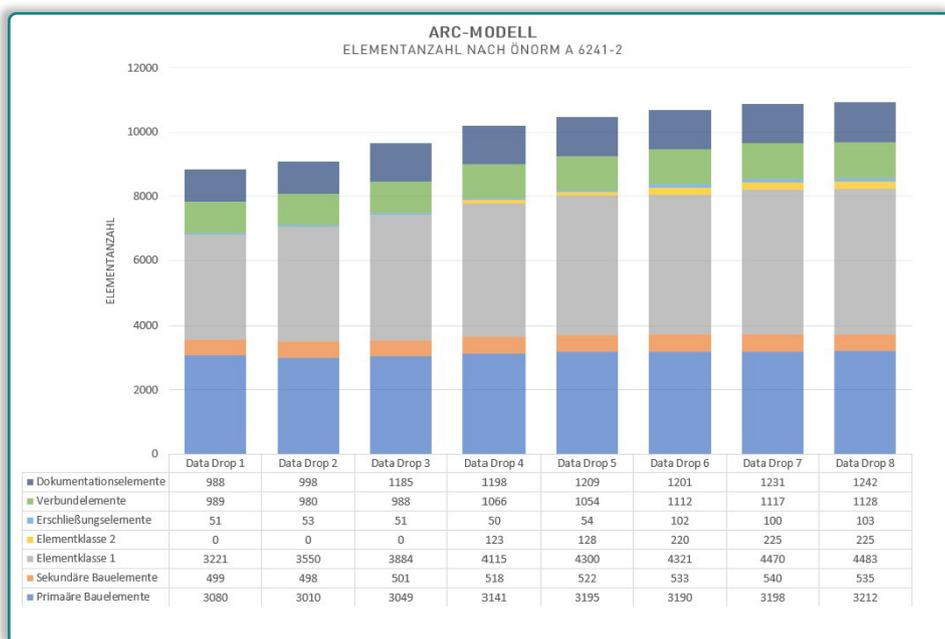
Abbildung 4: Modellstandvergleich – Elementanzahl nach Klassifikationsgruppen der ÖNORM A 6241-2
