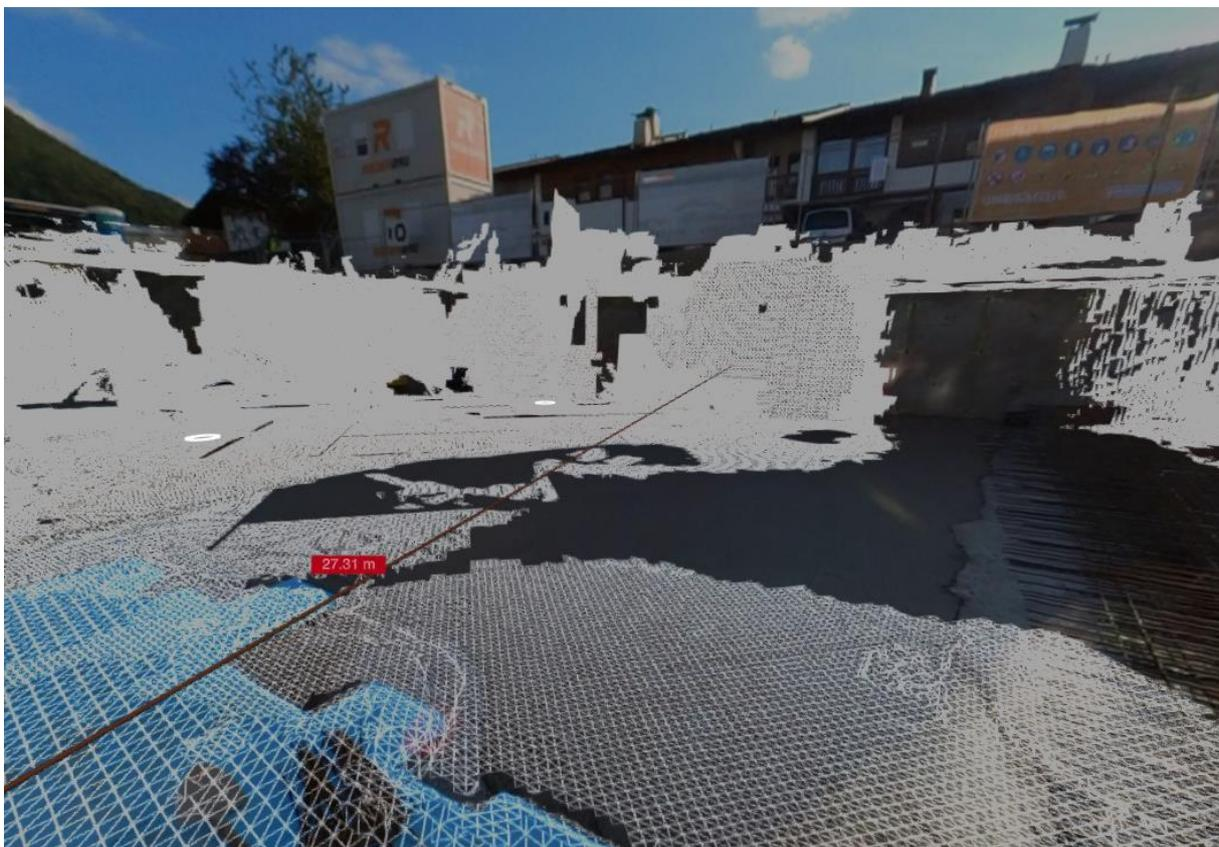
Abbildung 102 Hilti Reality Capture – Bemaßung der vermaschten Baugrube
