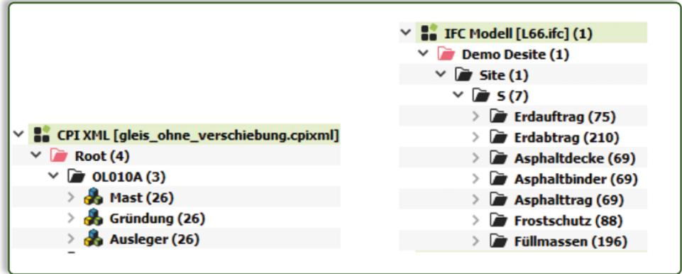
Abbildung 3: Datenstruktur von CPIXML und IFC im Desite MD pro
