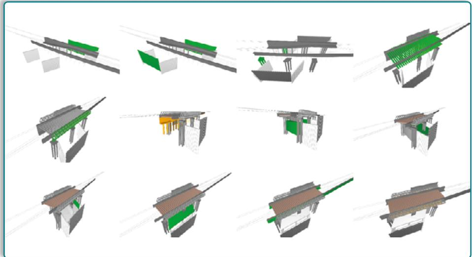
Abbildung 1: Beispiel einer Bauablaufsimulation
