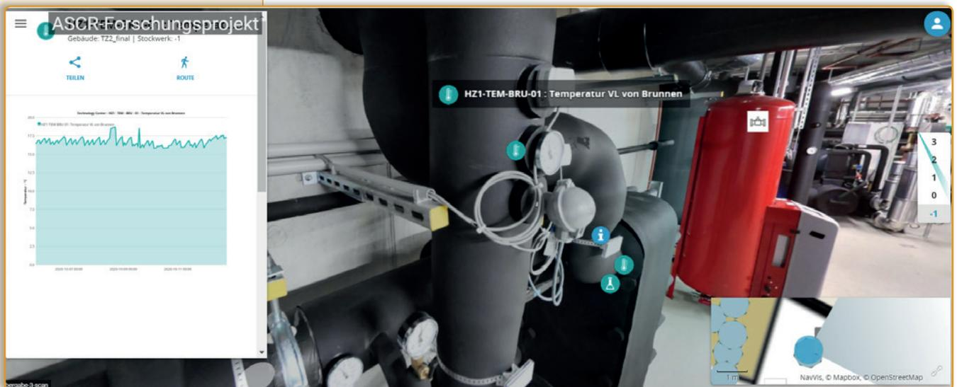
Abb. 12: Integration von Datenpunkten aus der Gebäudeautomation in den NavVis Indoor Viewer
